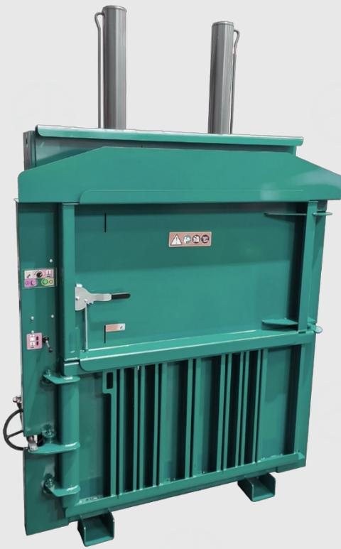
Die PAB 550 ist für die Verdichtung von Ballen mit einem Gewicht von bis zu 550 kg ausgelegt. Diese Maschine ist mit verschiedenen Optionen erhältlich (Guillotine, manuell, automatisch), sodass sie sich optimal an die Bedürfnisse und das Budget von Unternehmen anpassen lässt. Dieses Modell eignet sich besonders für Unternehmen, die mehr als 70 TB Abfall pro Jahr zu verpressen haben oder über große Kartonagen oder Plastik verfügen.
