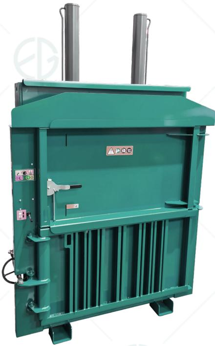
La PAB 450 est conçue pour compacter des balles pesant jusqu'à 450 kg. Cette machine se décline en diverses options (porte guillotine, manuel, automatique,) ce qui lui permet de s'adapter au mieux aux besoins et au budget des entreprises. Ce modèle est parfaitement adapté pour des entreprises ayant plus de 50 To de déchets par année à compacter ou disposant de cartons ou plastique de grande taille. La taille de ses balles est parfaitement adaptée aux palettes EUR/EUR1.
